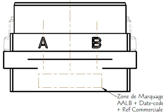
**Une seule operation de marquage est necessaire / We can mark the receptacle in a single operation.**
